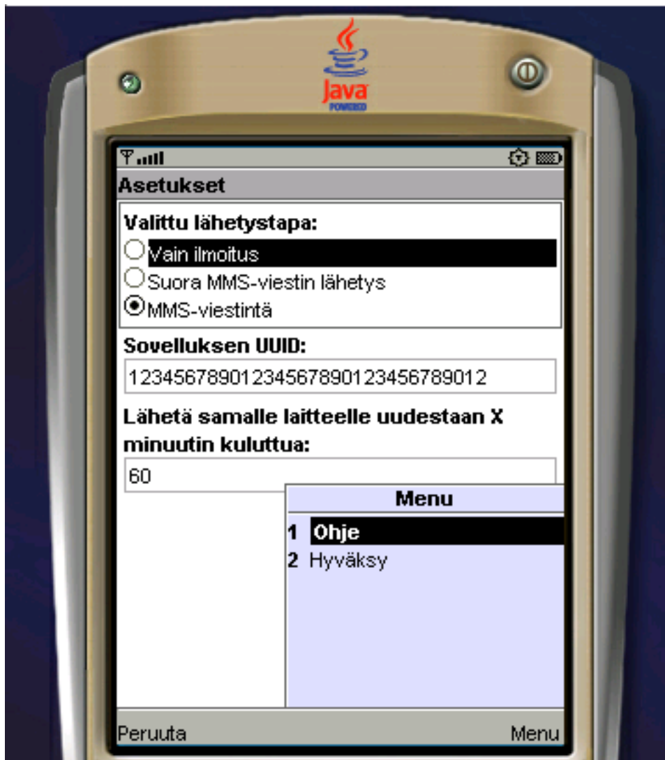
Kuva A.11: Sovelluksen yleisten asetusten määrittäminen. Valittavana on lähetystapa, sovelluksen tunniste (UUID) ja se, kuinka usein viesti voidaan lähettää samalle päätelaitteelle uudestaan.
